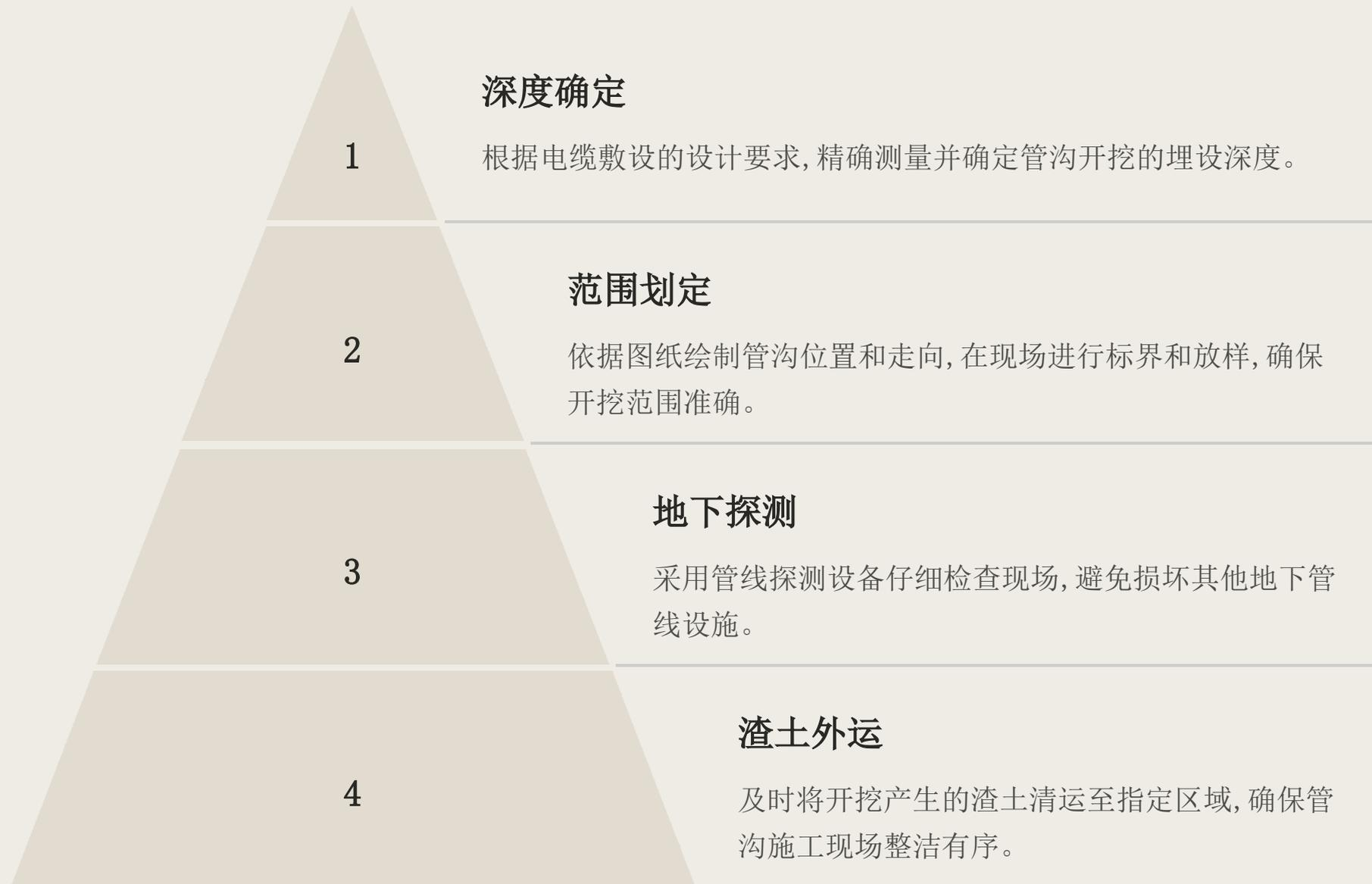
管沟开挖是电缆敷设项目的关键前置工序。施工团队需要根据设计图纸精准测量管沟的埋设深度和位置, 并采取管线探测等措施避免损坏其他地下设施。同时要做好开挖过程中的渣土清运工作, 确保现场环境整洁有序。
