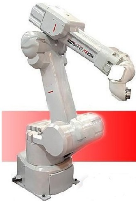
图 2.2 喷涂机器人基本形式示意图 [9]
