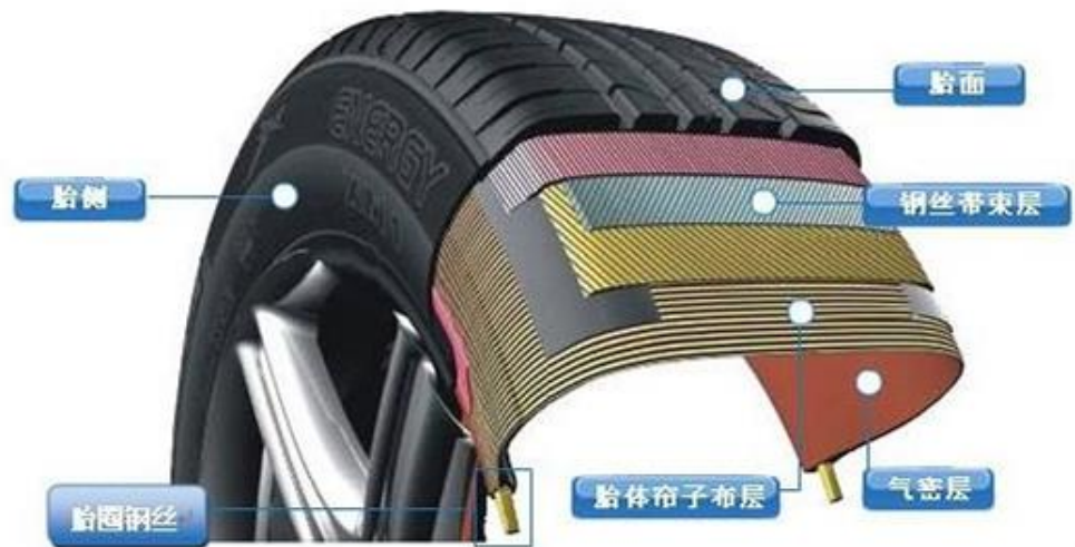
图表 13: 子午线轮胎的结构图示
