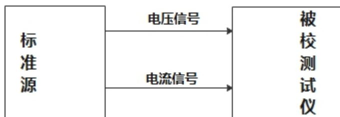
图 1 标准源法接线图
