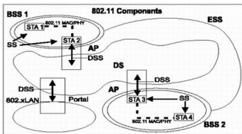
扩展服务区是指由多种 AP 以及连接它们的分布式系统构成的构造化网络，所有 AP 必需共享同一种扩展服务区标示符（ESSID），也可以说扩展服务区 ESS 中包括多种 BSS。分布式系统在 802.11 原则中并没有定义，不过目前大都是指以太网。扩展服务区是一种 Layer 2 网络构造，对于高层协议例如 IP 来说，它是一种子网。
