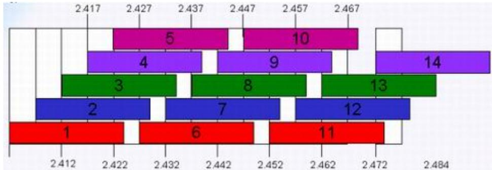
在多种频道同步工作的状况下，为保证频道之间不互相干扰，原则规定两个频道的中频间隔不能低于 25MHz。因此从上图可以看出，在一种蜂窝区内，直序扩频技术最多可以提供 3 个不重叠的频道同步工作，提供高达 33Mbps 的吞吐量。
