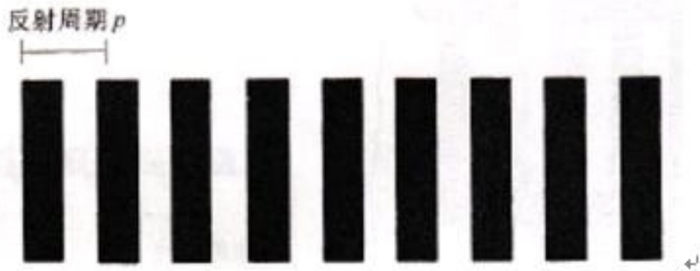
图 11.4 适用于表面波的简单反射器的几何图形
