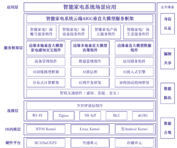
图32: 应用大模型的人工智能家电系统结构框架图
