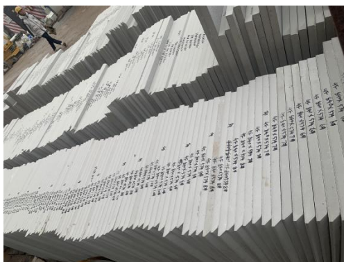
图 5.3.3 发泡陶瓷保温板成品加工及编码堆放
