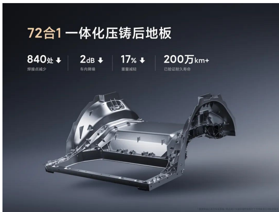
图 10：制造和材料的双突破，成功打造 72 合 1 的一体化压铸后地板
