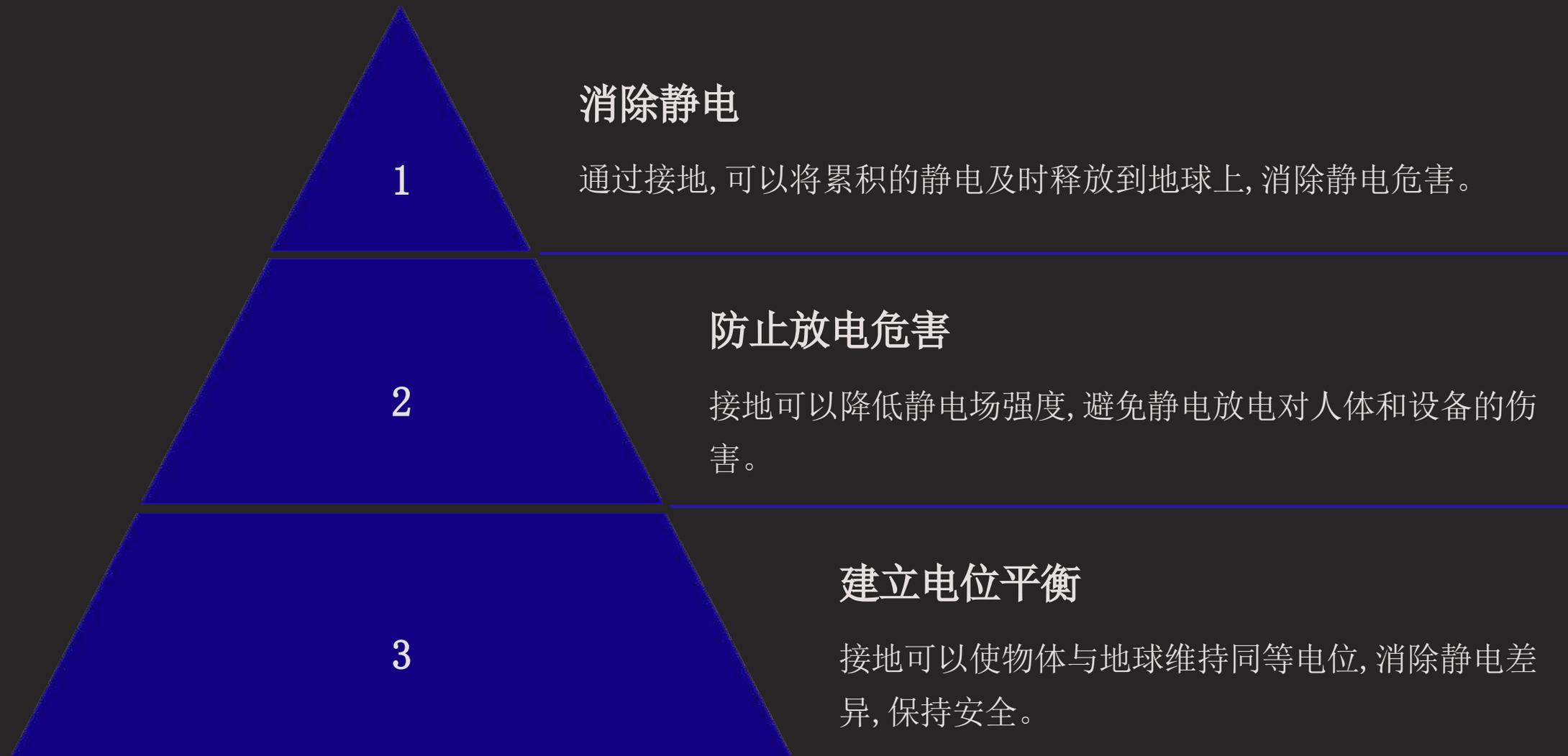
静电的接地作用是静电防护的重要措施。通过接地, 可以有效消除静电积聚, 防止静电放电导致的伤害, 并建立电位平衡, 确保系统和人员的安全。
