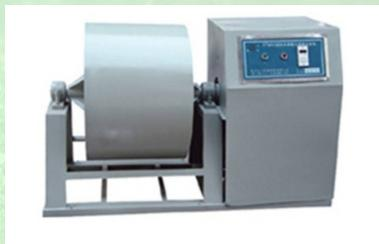
洛杉矶式磨耗试验(又称搁板式磨耗试验)
