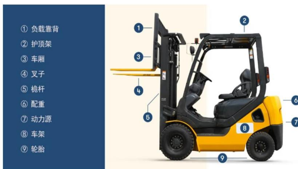
图 5：叉车主要零部件结构
