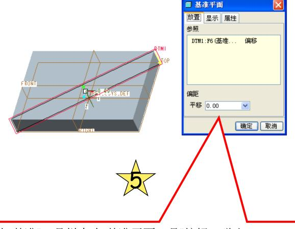
再次单击"基准"工具栏中的"基准平面工具"按钮,弹出"基准平面"对话框,系统自动将前面创建的**DTM1**基准平面作为参照平面,并经过偏移措施创建新平面,且偏移距离为**O**
