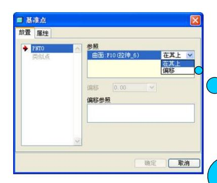
创建基准点的一般措施 是,单击"基准"工具 栏中"基准点工具"按 钮,打开"基准点"对 话框。在该对话框中设 置基准点的参照对象、 参照类型和偏移参照
