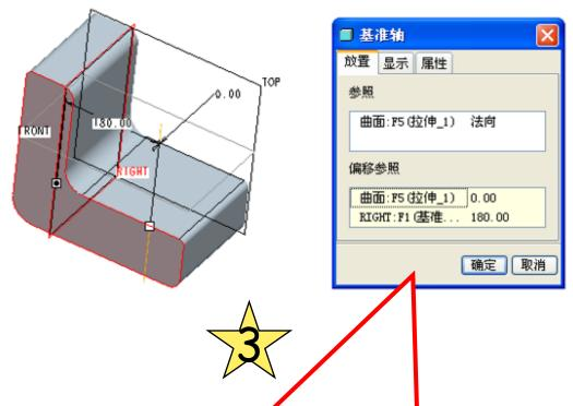
在"基准轴"对话框的"偏移参照"区单击将其激活,按住【Ctrl】键依次单击选择"RIGHT"基准平面和模型侧面,设置侧面的偏移值为"O"(虽然基准轴落在侧面上),"RIGHT"偏移值设置为"180",最终单击"拟定"按钮,完毕创建
