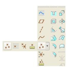
在零件模式下,单击"基准"工具栏中"基准点工具"按钮旁边的"展开"按钮,会显示4种基准点创建工具按钮。另外,还能够选择"插入">"模型基准">"点"菜单,找到相应的基准点创建命令
