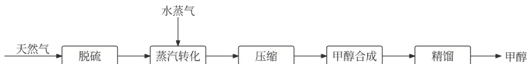
图5：灰色甲醇工艺（天然气制甲醇）流程图
