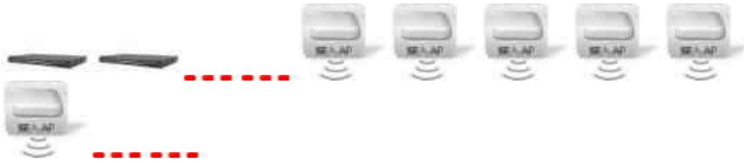
目前深信朋信锐推荐使用的无线组网方式为NAC+FIT AP的方式,采用无线集中管理的方式,方便管理,方便维护,即插即用;旁挂式组网是控NAC旁挂在在汇聚交换机旁边,实现对AP的WLAN业务管理。在旁挂式组网中,NA C管理AP是通过NAC和AP之间的控制隧道传输的。数据业务流可以通过数据隧道经NAC转发,也可以不经过NAC直接转发。
