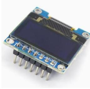
图 2-4 OLED 屏幕模块
