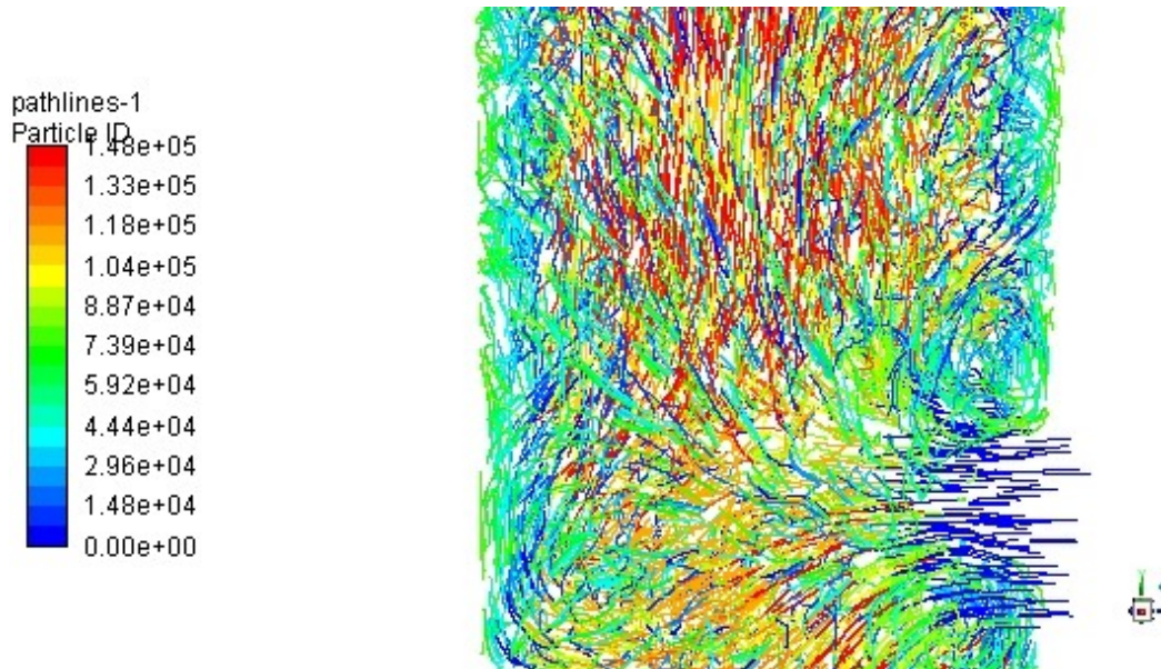
图 4 脱硫塔进口左侧流场
