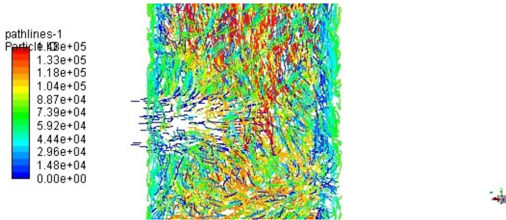
图 1 脱硫塔进口右侧 45° 流场
