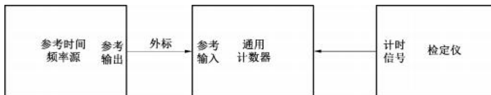
图 4 时间间隔测量误差校准接线图
