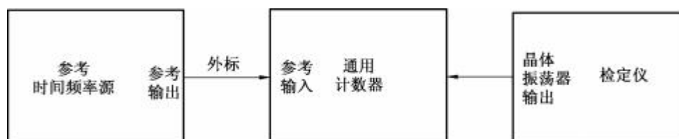
图 3 内部晶体振荡器校准接线图
