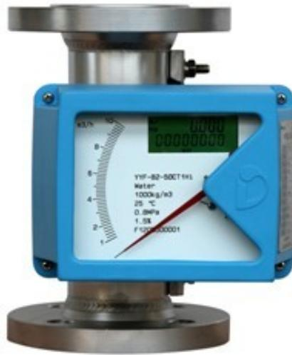
(1) 工作原理: 被测流体从下向上经过锥管 1 和浮子 2 形成的环隙 3 时, 浮子上下端产生差压形成浮子上升的力, 当浮子所受上升力大于浸在流体中浮子重量时, 浮子便上升, 环隙面积随之增大, 环隙处流体流速立即下降, 浮子上下端差压降低, 作用于浮子的上升力亦随着减少, 直到上升力等于浸在流体中重量时, 浮子便稳定在某一高度。浮子在锥管中高度和通过的流量有对应关系。
