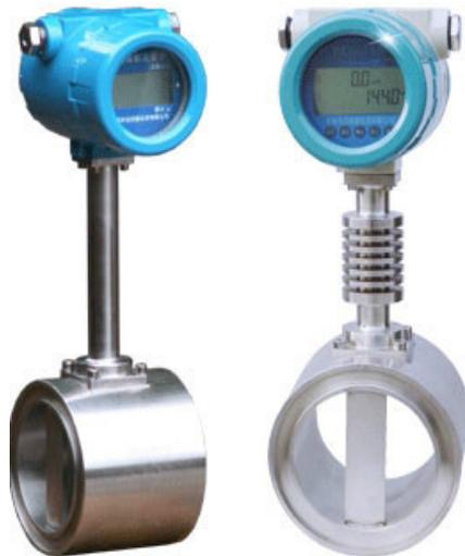
涡街式流量计是应用流体振荡原理来测量流量的，流体在管道中经过涡街流量变送器时，在三角柱的旋涡发生体后
