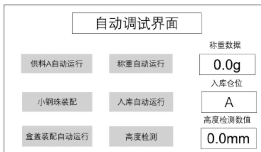
图 7 触摸屏（HMI）自动调试界面（参考）
