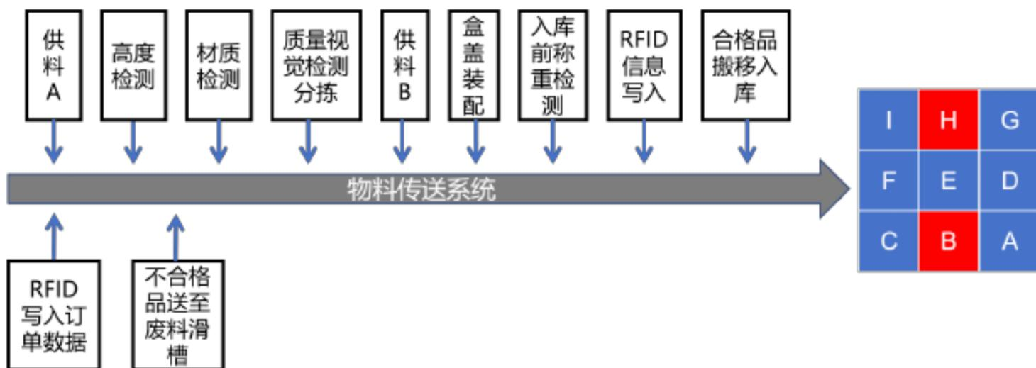
图 1 系统工艺流程示意图（参考）
