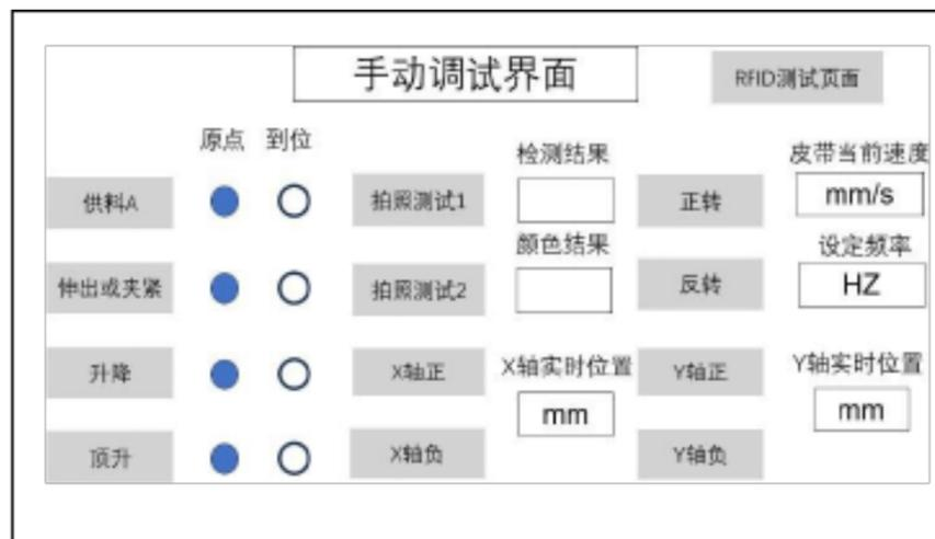
图 6 触摸屏（HMI）手动调试界面（参考）
