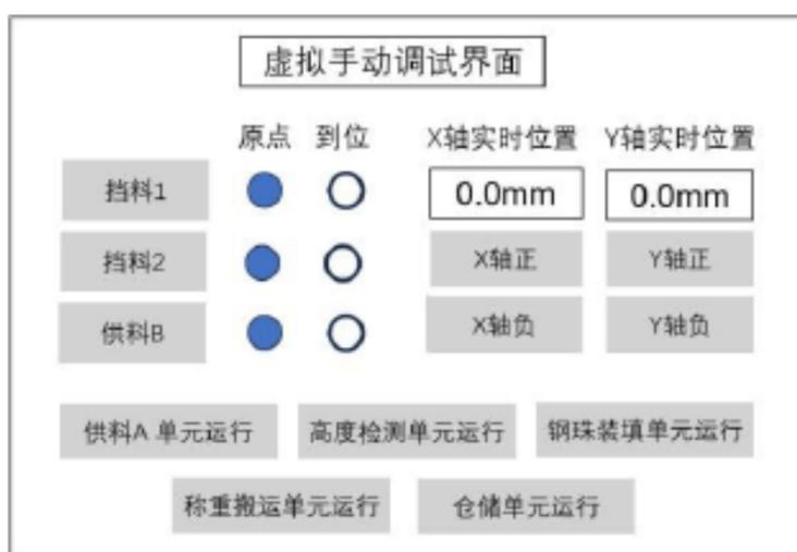
图 3 虚拟手动调试界面示意图（参考）
