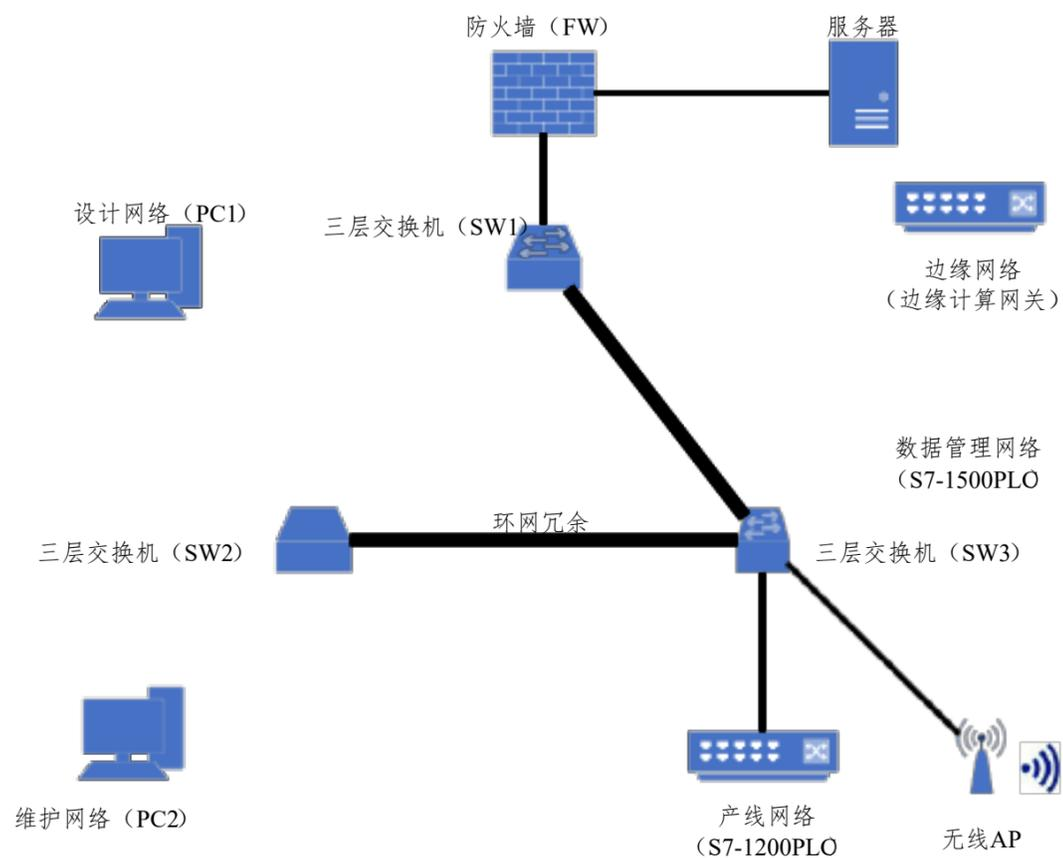
图 2 工业网络系统结构示意图
