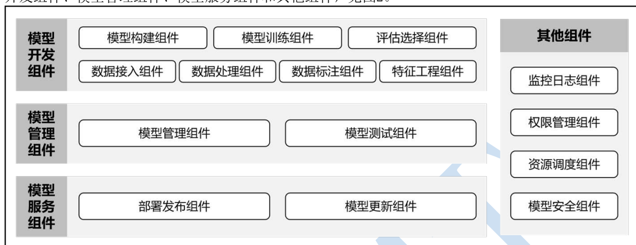
图2 工业模型组件总体架构图
