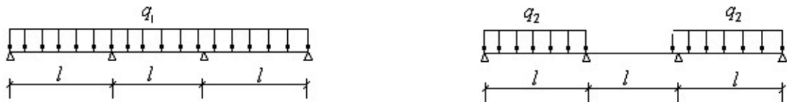
支架横梁计算荷载组合简图(跨中最大弯矩和跨中最大挠度)
