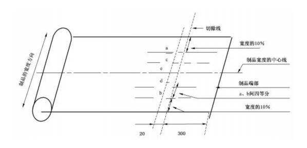
图 1 厚度测量点示意图
