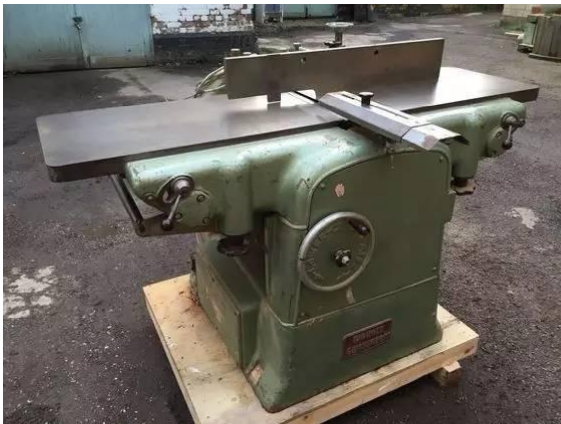
平刨机：刨基准面和垂直面
