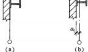
图 4.4.2 墙、边柱与纵向定位轴线的定位
