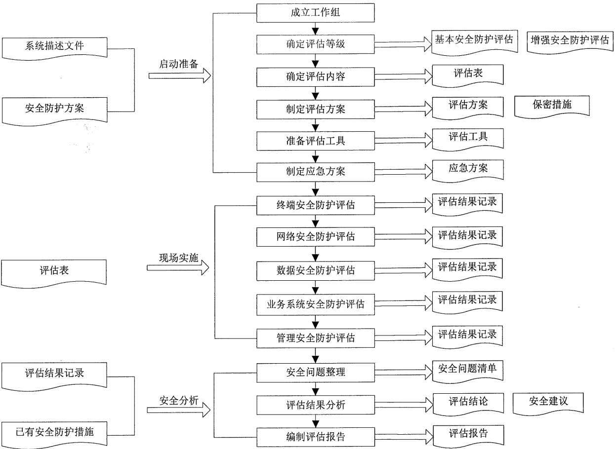
图1 基于 5G 网络的电力业务系统安全防护评估流程
