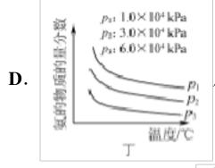
反应达平衡时,混合气体中氨的物质的量分数随温度、压强的变化
