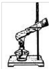
2. 如图所示，用酒精灯加热试管中的水，当水沸腾一段时间以后，塞子被试管内水蒸气推出，水蒸气的\_\_\_\_\_能转化为塞子的机械能。热机是通过燃烧燃料将\_\_\_\_\_能
