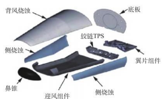
图表21：IXV 飞行器热防护结构
