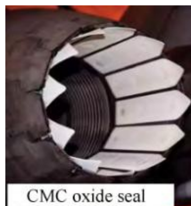
图表13： F414 的 Ox/Ox 封严片
