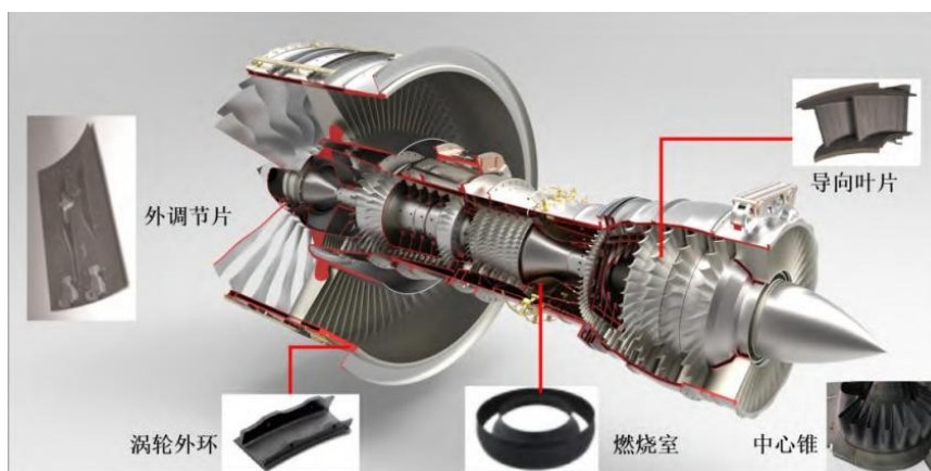
图表10：CMC 在航空发动机上已经实现应用的部位
