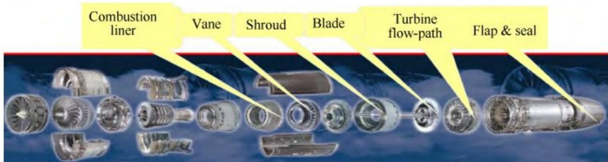
图表8：CMC 可应用在航空发动机上的部位
