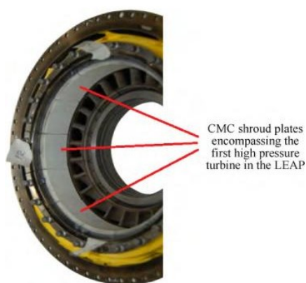
图表14： LEAP 发动机的 CMC 涡轮外环
