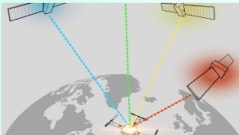
精密单点定位 ( PPP ) 技术是一种利用GNSS卫星信号进行高精度定位的方法。
