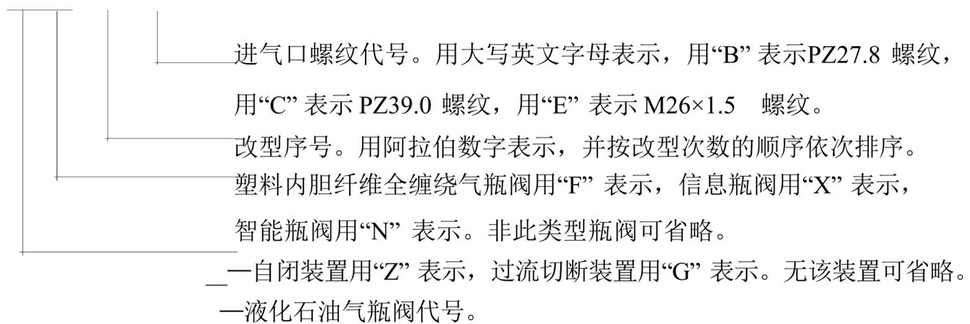
注：为适应用户长期使用惯例，表示 PZ27.8 的螺纹代号“B”在型号编制中可省略。
