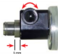
VTL适配器将磁性底座的运动限制在轴上一个方向运动，移动范围为5 mm。
