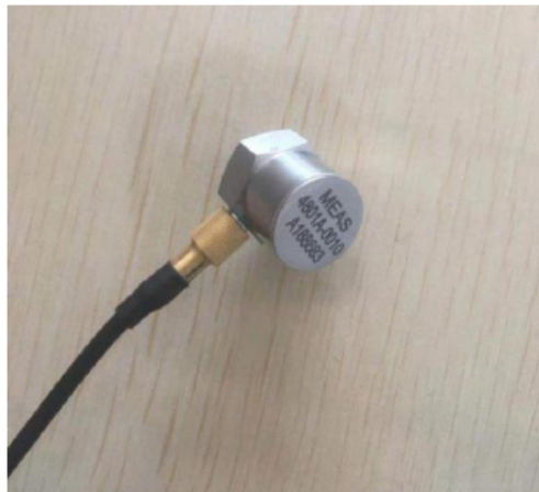
图 2.1 MEAS4801A 加速度传感器
