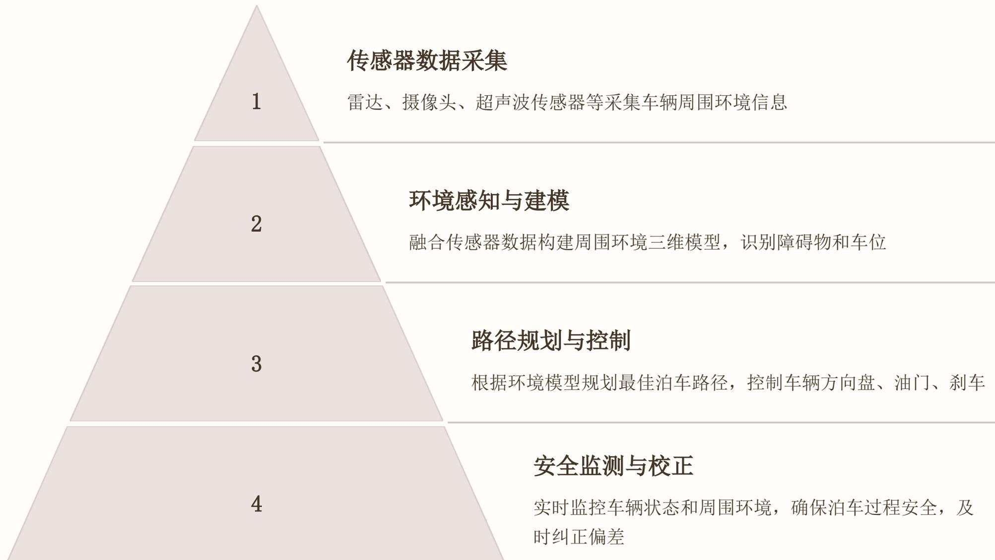
自动泊车技术通常采用多传感器融合方案，通过雷达、摄像头、超声波传感器等获取车辆周围环境信息，并将其融合成三维模型。基于此模型，系统进行路径规划并控制车辆完成泊车动作。同时，系统会进行安全监测，确保泊车过程安全，并及时纠正偏差。
