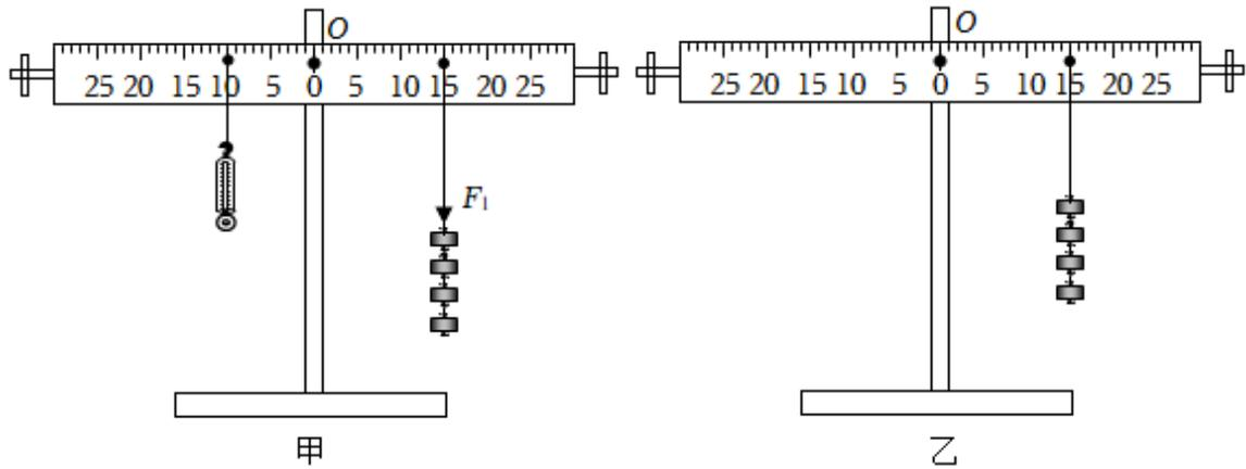
(1) 调节平衡螺母，使杠杆在不挂钩码时，保持水平并静止。选取若干个质量均为 50g 的钩码，在杠杆两侧分别挂上不同数量的钩码，移动钩码，使杠杆重新在水平位置平衡，分别记下  $F_1$ 、 $F_2$ 、 $l_1$ 、 $l_2$  的数值。重做几次实验，部分实验数据如表所示。
