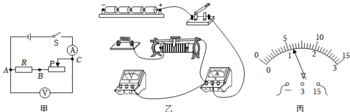
(1) ①如图乙所示，电压表量程为  $0\sim 15V$ ，电流表量程为  $0\sim 0.6A$ ，定值电阻  $R=10\Omega$ ，请根据图甲在图乙中补画 2 根导线，将实物电路连接完整。
