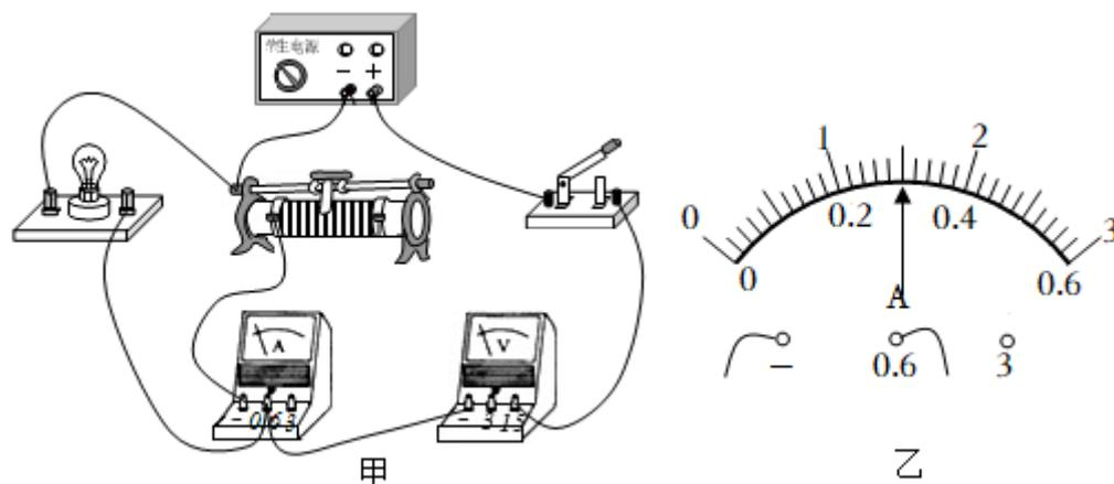
(1) 图甲中有一根导线接错了，请你在这根导线上打“×”，并补画出正确的那根导线。
