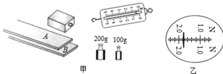
将物块放在水平放置的长木板上，再把砝码放在物块上，用弹簧测力计水平拉动物块，沿长木板做匀速直线运动，实验记录如表：
