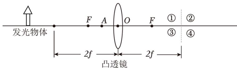
(1) 发光物体和凸透镜的位置如图所示，图中光屏未画出，光屏上所成清晰的像在图中 ③ (填数字序号) 区域，像的箭头方向是竖直向 下 的，像的大小比发光物体要 小。
