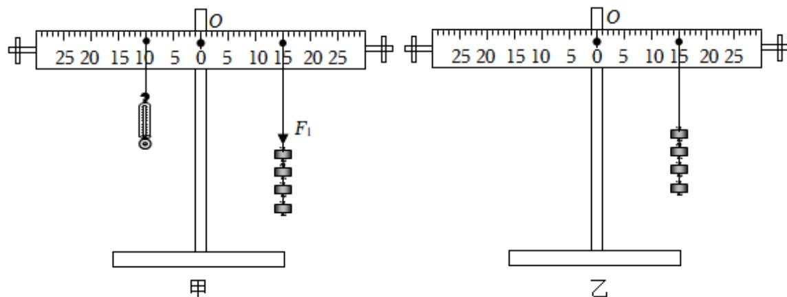
(1) 调节平衡螺母，使杠杆在不挂钩码时，保持水平并静止。选取若干个质量均为 50g 的钩码，在杠杆两侧分别挂上不同数量的钩码，移动钩码，使杠杆重新在水平位置平衡，分别记下  $F_1$ 、 $F_2$ 、 $l_1$ 、 $l_2$  的数值。重做几次实验，部分实验数据如表所示。
