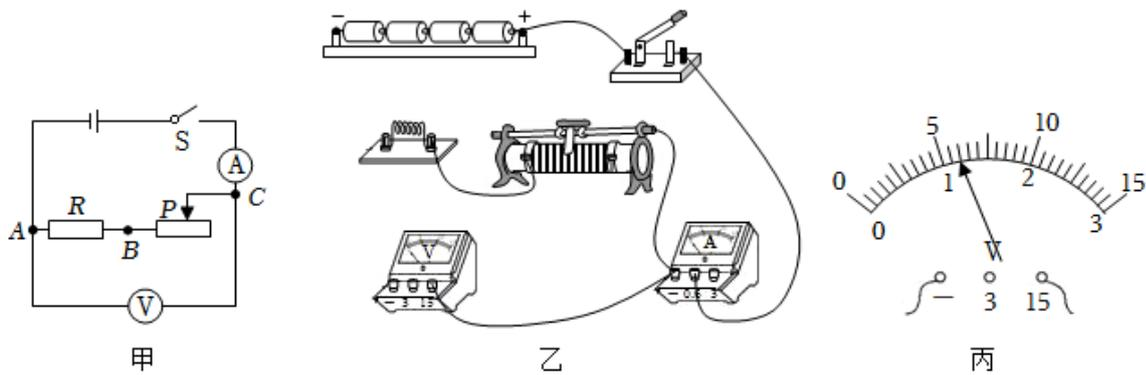
(1) ①如图乙所示，电压表量程为  $0\sim 15\text{V}$ ，电流表量程为  $0\sim 0.6\text{A}$ ，定值电阻  $R=10\Omega$ ，请根据图甲在图乙中补画 2 根导线，将实物电路连接完整。
