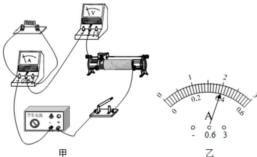
(1) 该同学接错了一根导线，请你在该导线上打“×”，并补画出正确的那根导线；
