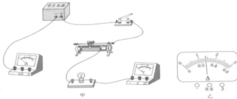
(1) 如图甲所示，电路中还有两根导线没有连接，请你将电路连接完整。（要求：导线不允许交叉）
