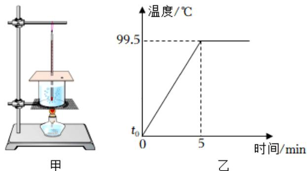
(1) 实验中可以看到，水沸腾时形成大量的气泡不断上升、\_\_\_\_\_ (填“变大”“变小”或“不变”)，到水面破裂开来，里面的水蒸气散发到空气中。水蒸气遇冷 \_\_\_\_\_ (填“汽化”“液化”“升华”或“凝华”)，在烧杯口周围形成“白气”。
