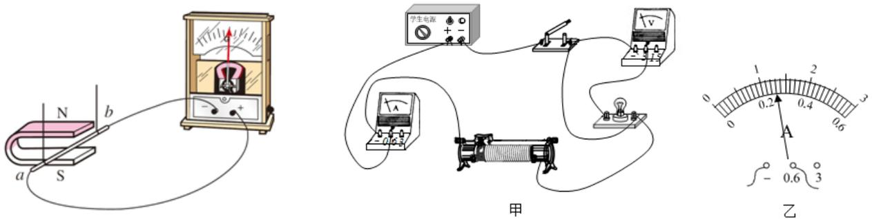
20. 某同学利用图甲所示的电路测量小灯泡的电功率。实验中电源电压保持不变, 小灯泡的额定电压是 2.5V。
