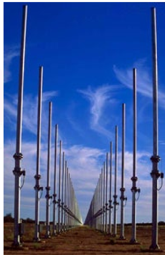
多个直立振子天线组合的平面天线阵
