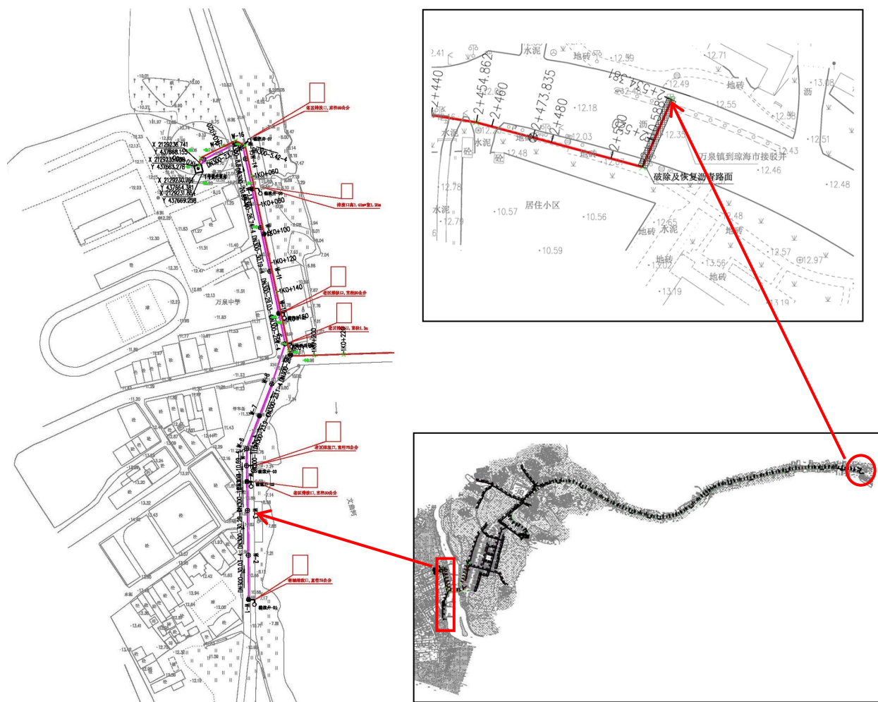
图 1-3 本项目新建管道与现有污水管道接驳口
