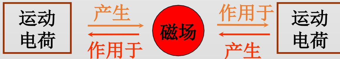
运动的电荷(电流)产生磁场,磁场对运动电荷(电流)有磁场力的作用.一切磁现象都可以归结为运动电荷(电流)之间通过磁场发生的相互作用.这就是磁现象的电本质.
