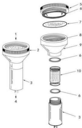
1——气流入口；2——滤膜及滤膜支撑架；3——采样筒架；4——气流出口；5——滤膜上压环；6——硅橡胶密封圈；7——滤膜；8——滤膜支撑网；9——滤膜支撑架；10——玻璃采样筒。
