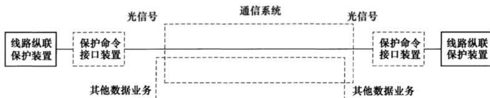
图 A.3 采用 2Mbit/s 光信号复用通道方式的线路纵联保护系统
