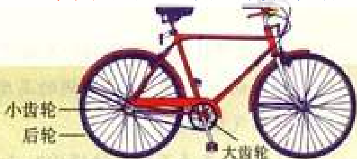
图 6.5-2 自行车的轮盘、飞轮、后轮中的质点都在做圆周运动。哪些点运动得更快些？
