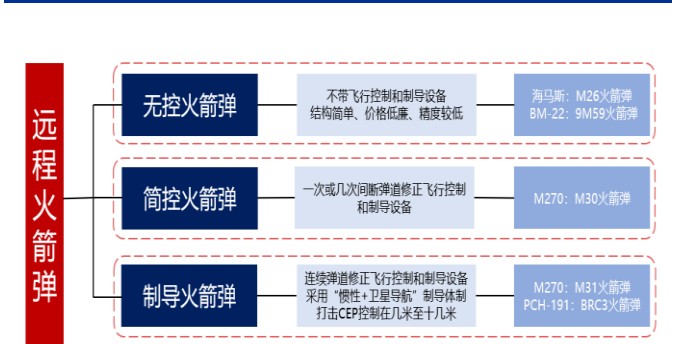
图 5：远程火箭弹按制导方式可划分为三类
