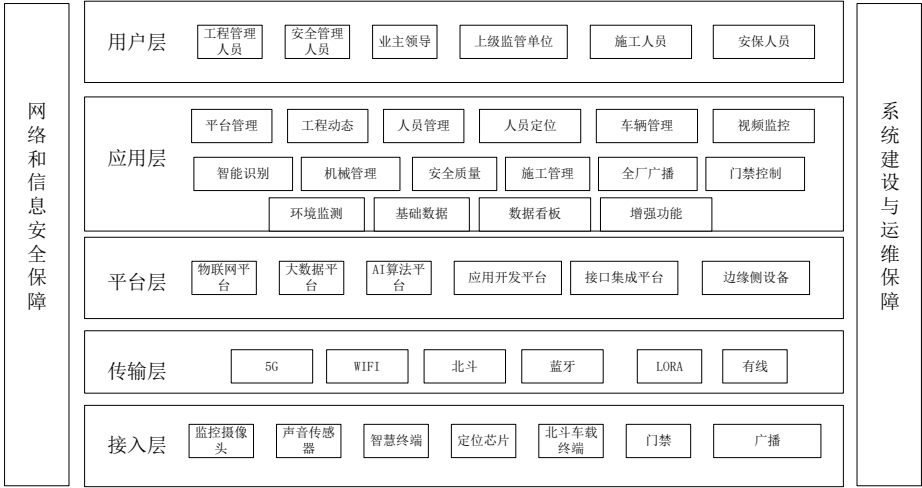
图 1 智慧工地管理系统架构图
