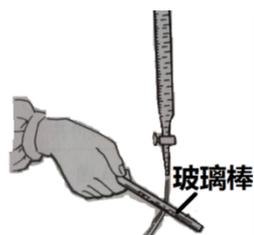
带电玻璃棒靠近液流实验
