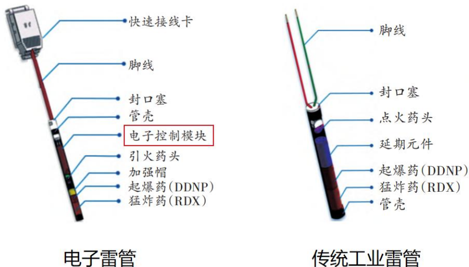
图43: 电子雷管与传统工业雷管结构示意图
