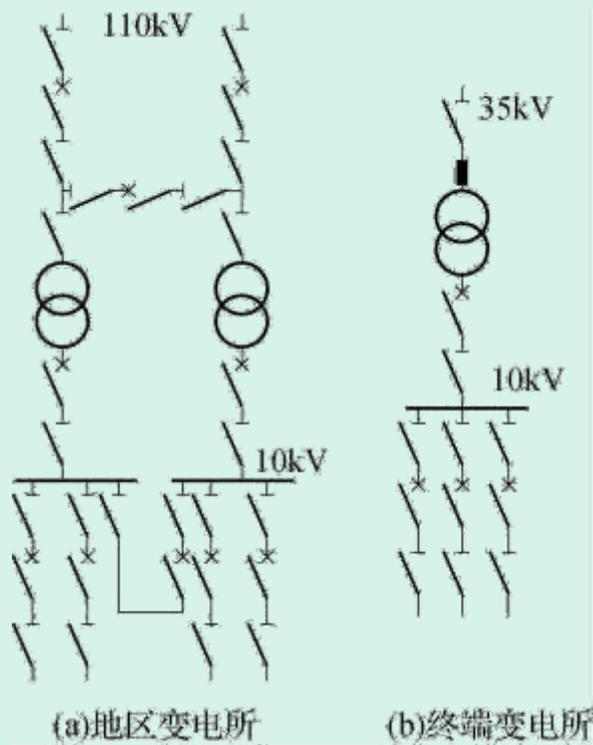
图 3-22 地区和终端变电所电气主接线图
