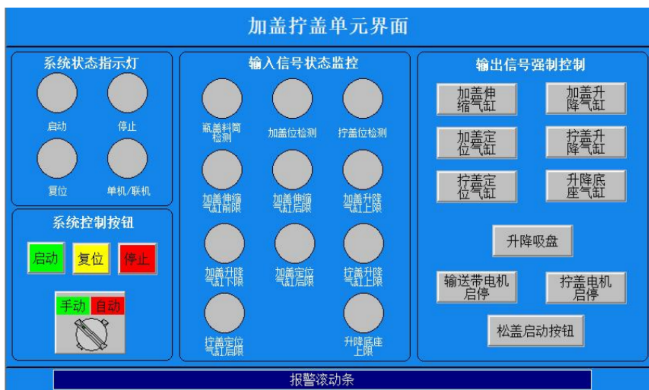
图 4-3 加盖拧盖单元监控界面布局图
