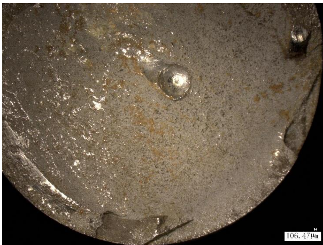
图 11，断口面键槽下部分形貌
