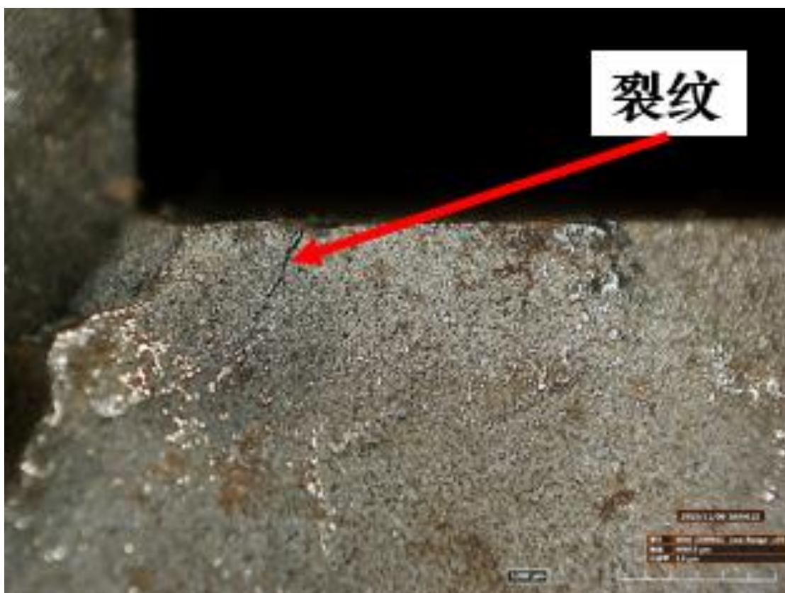
图 3，图 2 中靠近键槽处的裂纹与缺陷
