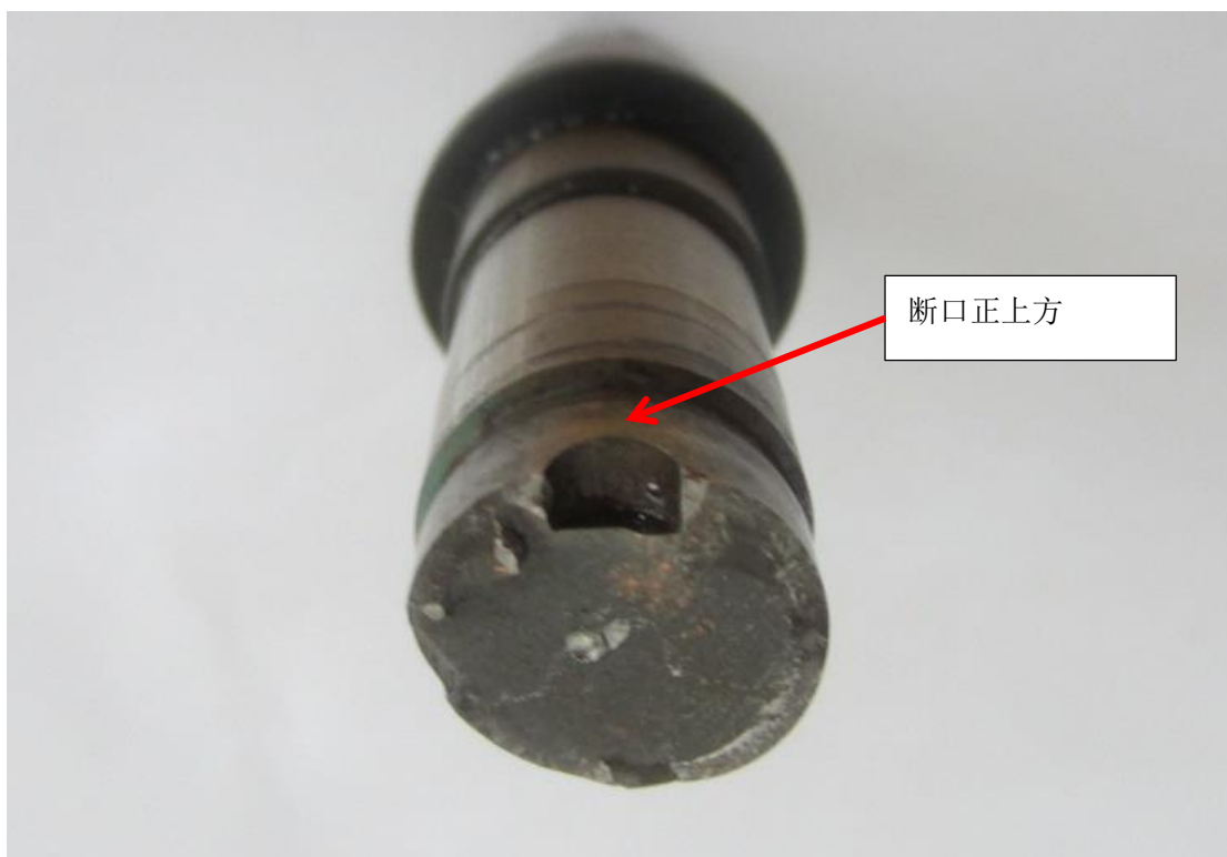
图 7，B 断口的外观形貌
