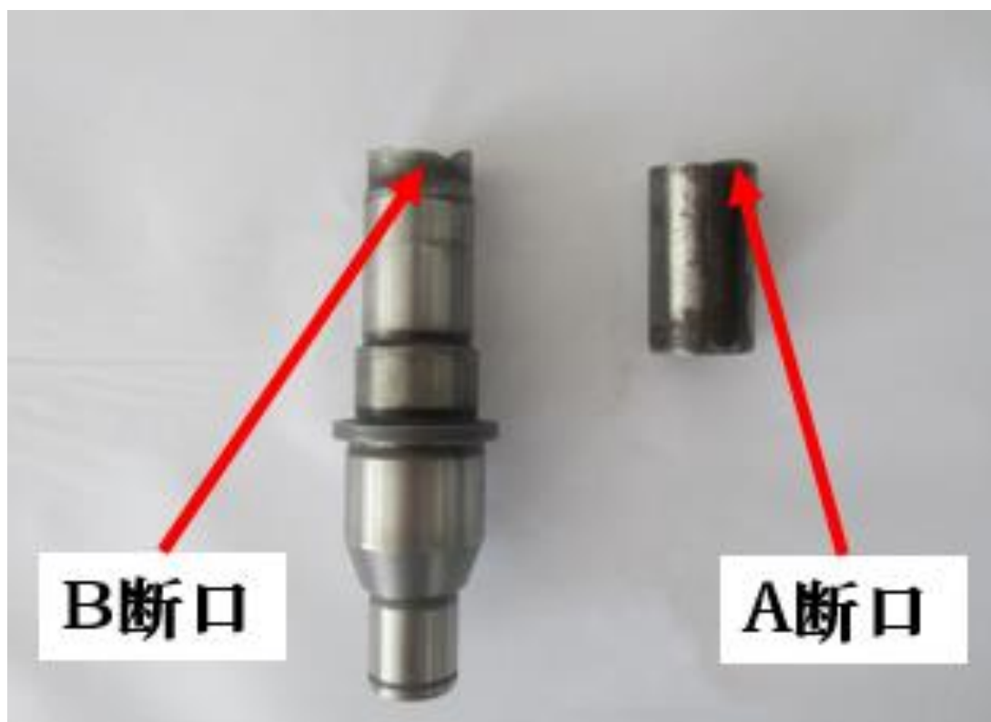
图 2，断裂轴两段的侧向形貌
