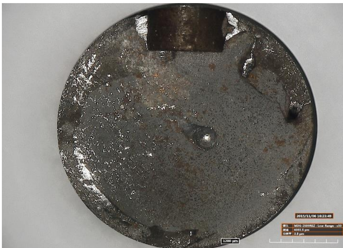
图 8, B 断口表面形貌
