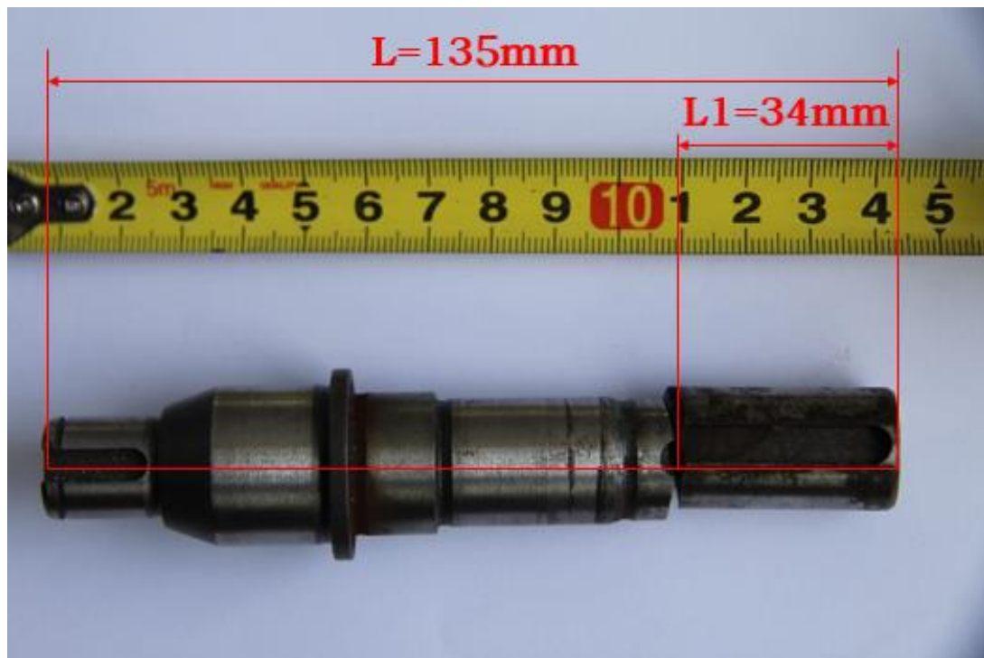
图 1，断裂件外观形状和尺寸
