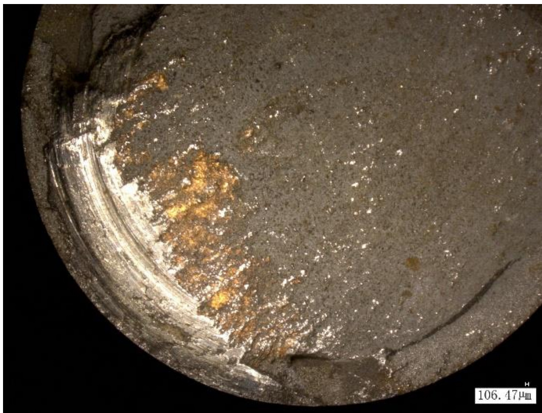
图 6，图 1 中“摩擦痕迹”与“凹陷”处形貌 失效轴 B 断口的宏观形貌
