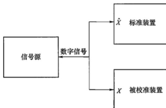
图 2 D 模式智能变电站数字信号试验装置比对方法校准示意图
