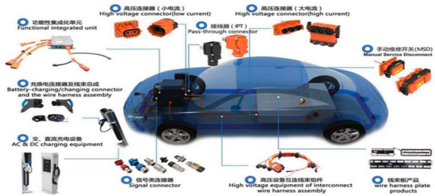
图11: 汽车连接器广泛分布于车内各个位置
